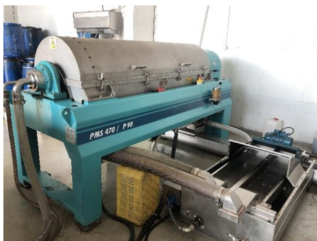
شکل ۶- دستگاه دکانتر در خط روغن کشی زیتون
