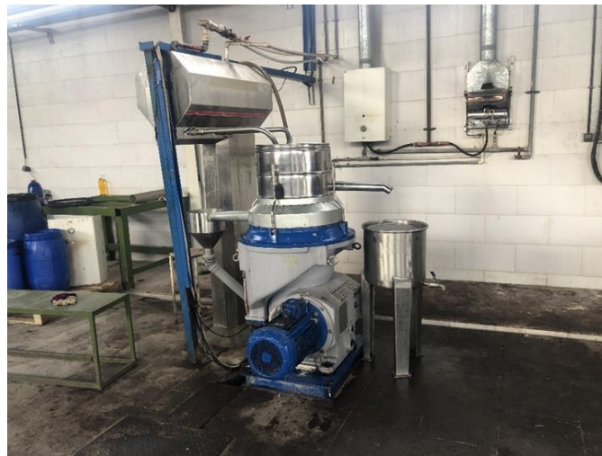
دستگاه ۷- دستگاه سیراتور در خط روغن کشی زیتون
