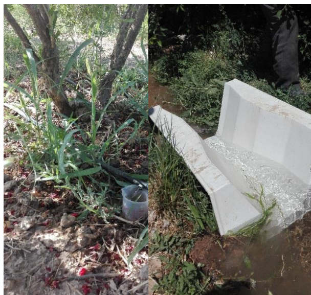
شکل ۲- اندازه‌گیری آب مصرفی در باغ‌های انار
