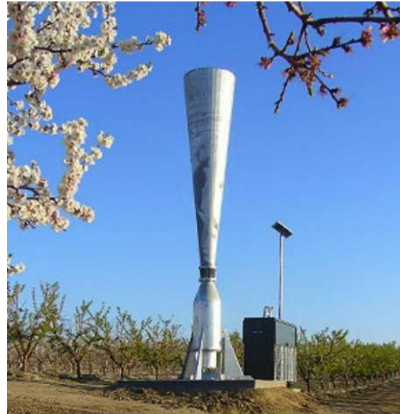
شکل ۸ - سامانه ضد تگرگ
